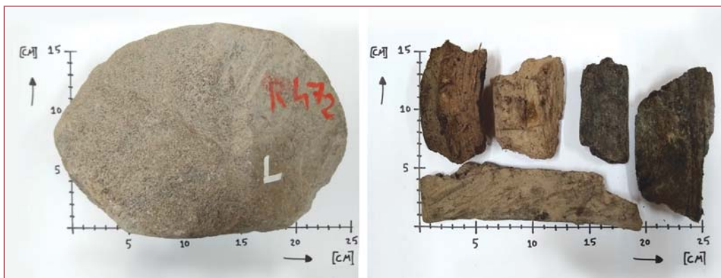
Figuur 6 – Door de tunnelboormachine ontgraven steen en stukken hout.
