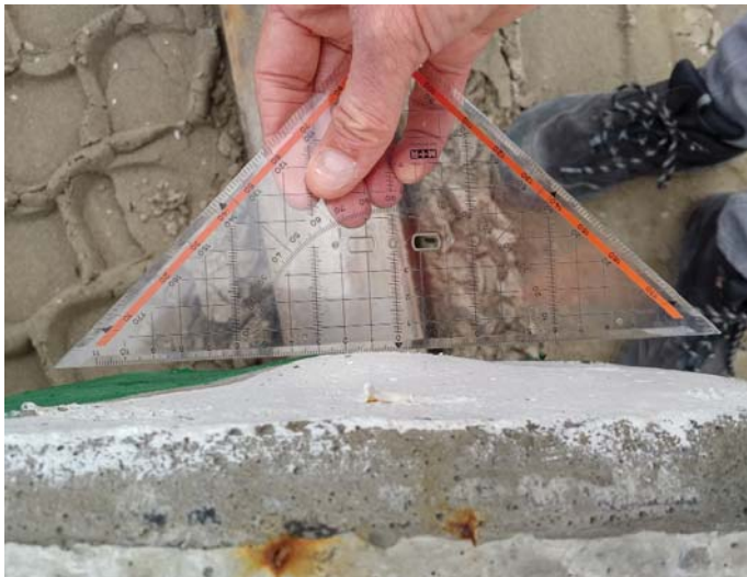
Figuur 13 – Links: weergave van de grootte van de heiknobbel op de geprefabriceerde betonpalen. Rechts: installatie van de paaldeksels op de paalkoppen met daar tussen het oplegrubber met opening.
