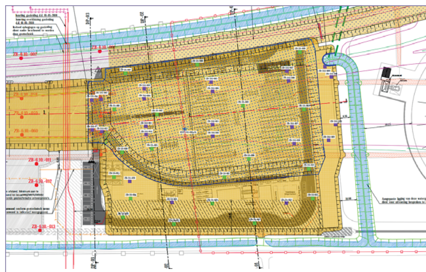
Figuur 5 – Overzicht voorbelastingsmaatregel Westelijk deel Tunnellogistiek terrein.
